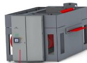
Automatisches Spleißen der Papierrollen, um den Druck ohne Produktionsunterbrechungen fortzusetzen.
